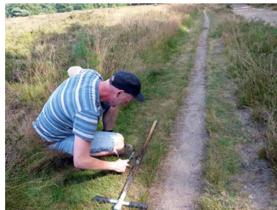
Met behulp van een zogenaamde ramguts is de bodemsamenstelling bepaald.
