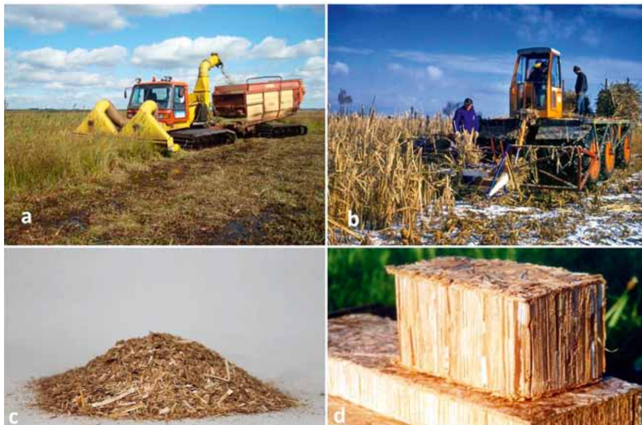
Figuur 3 Oogstmachines voor riet (linksboven a) en lisdodde (rechtsboven b). Riet kan toegepast worden als bouwstof maar ook als strooisel (c) in de veehouderij. Lisdodde is grondstof voor isolatie- en bouwmaterialen (d).
