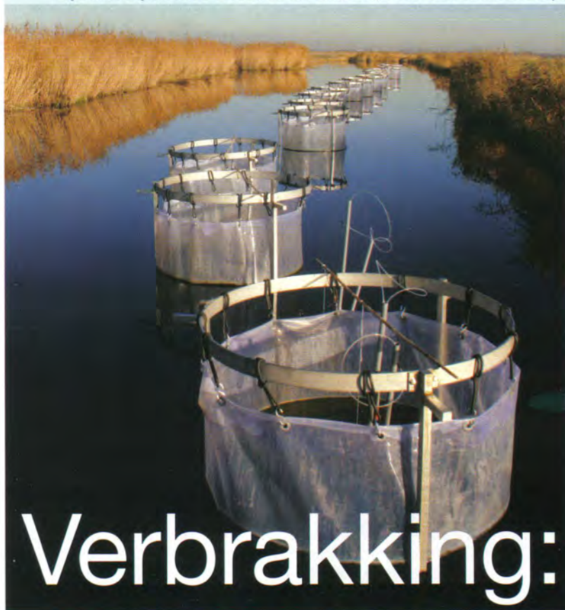
● De experimentele opzet met enclosures in het IJperveld. Foto: Gijs van Dijk.
